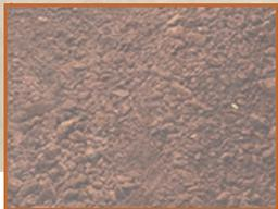
Die Erde am Bauplatz und der Umgebung eignet sich sehr gut für das Bauen mit Stampflehm. Der Aushub wird für Wände, Putz und Boden verwendet.
